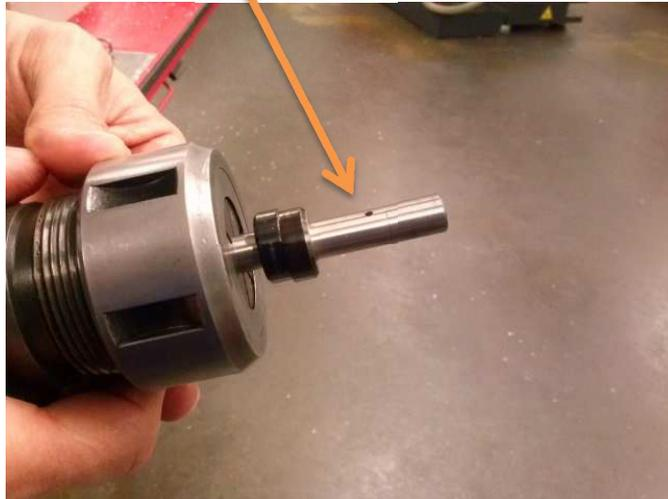
Abbildung 9: eingespannter Kantentaster (eigene Quelle, 2015)
