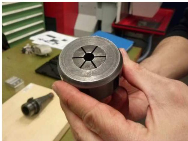
Abbildung 8: Spannzangenmutter mit Spannzange (eigene Quelle, 2015)
