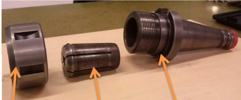
Abbildung 7: Spannzangenhalter (eigene Quelle, 2015)
