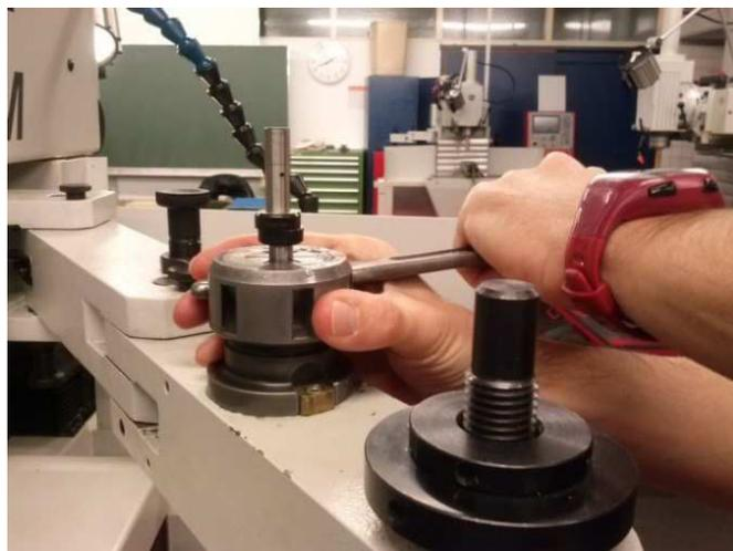
Abbildung 10: Spannen der Spannzange (eigene Quelle, 2015)
