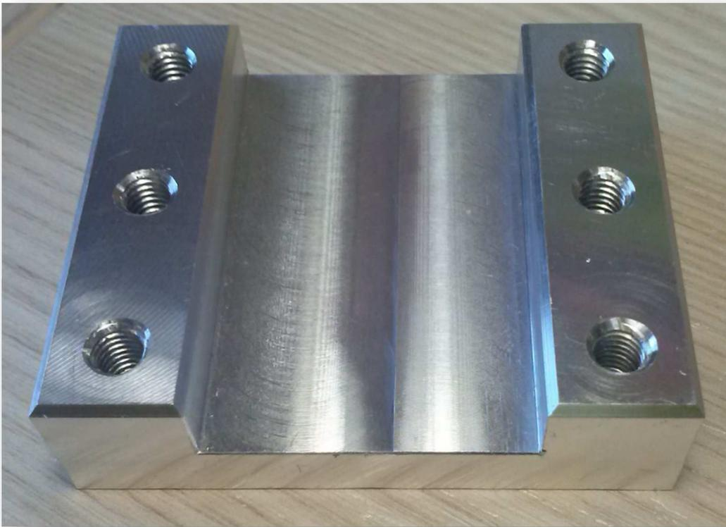
Abbildung 1: Nut einer Flachführung (eigene Quelle, 2015)
